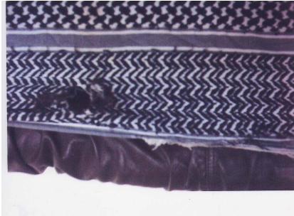
شكل رقم (4) عيب نتيجة سرعة المكوك
